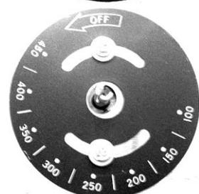
**Étape 4b.** – Régler le cadran de température et vérifier le réglage de la température
